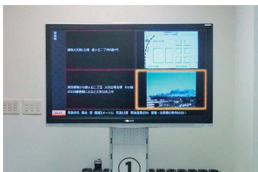
【写真②：4画面モニター】 1画面ずつ異なった付与情報を表示し、過去の情報が一定時間残るのが特徴
